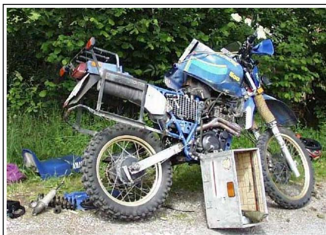
Abb. 2: Die Box als Hauptständerersatz bei Reparaturen
