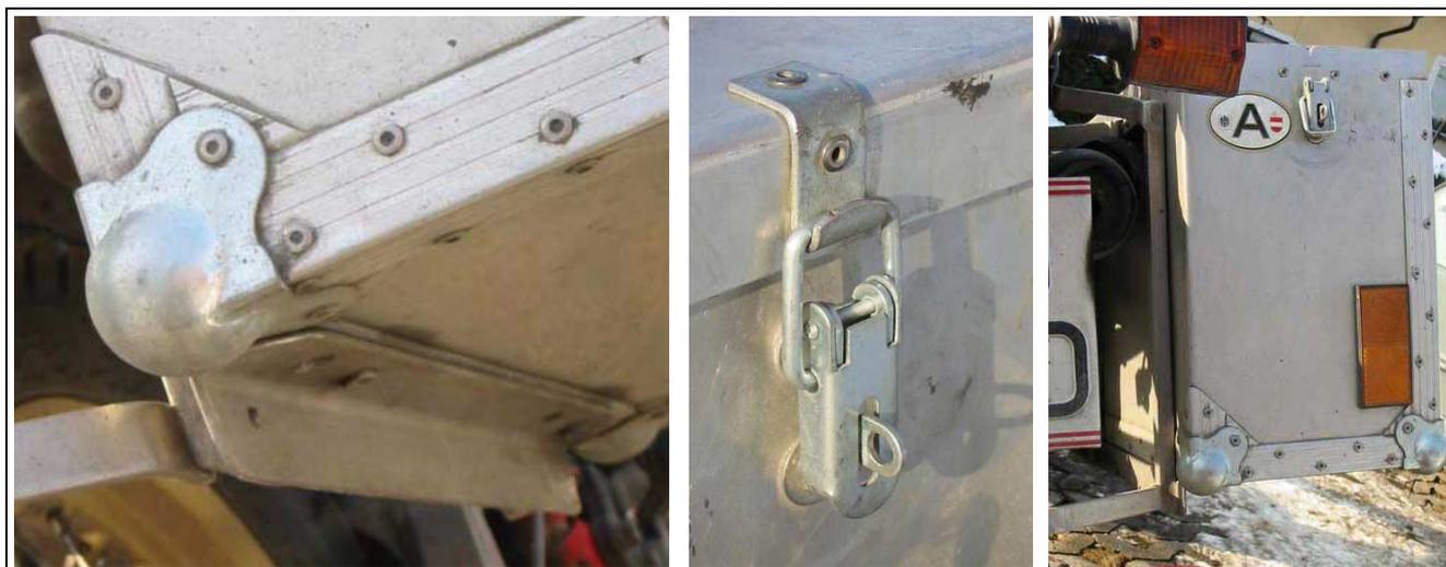
Abb. 5: Kofferauflager, von unten hinten gesehen; Schloss; Koffer von hinten.
