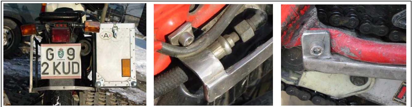
Abb. 12: Gernots Träger mit Querbügel von hinten: nah dran; Anschluß hinter der Ölleitung; Anschluss bei Fußraste.
